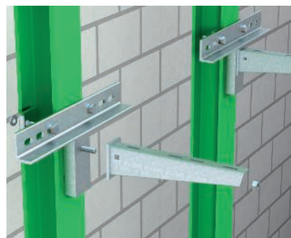
Svěrné upevnění k svislému ocelovému nosníku Montáž přídatného dílu typu KA-AW ke svislému ocelovému nosníku prostřednictvím úhlových svorek nebo upínacích svorek. K přídatném dílu se upevňují nástěnné výložníky typu AW pomocí šroubu se šestihrannou hlavou typu SKS 12x40 GF.
