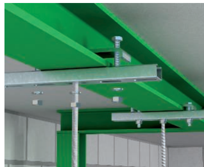
Upnutí profilové lišty C na nosník Upevnění profilu C typu MS 4022 nebo MS 5030 k ocelovému nosníku pomocí svěrných úhelníků typu KWS.
