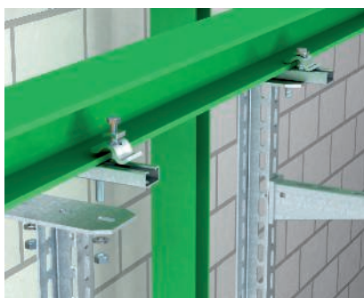
Krakovec z profilu C na ocelovém nosníku Použití dodatečné profilové lišty C typu MS u širokých ocelových nosníků. Průběh trasy podélně vůči ocelovému nosníku.
