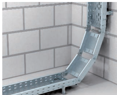
Montáž kloubového oblouku svislého, stoupajícího Kloubový oblouk svislý stoupací pro překlenutí výškových rozdílů. Kloubový oblouk se montuje pomocí kloubových spojek ke kabelovému žlabu.
