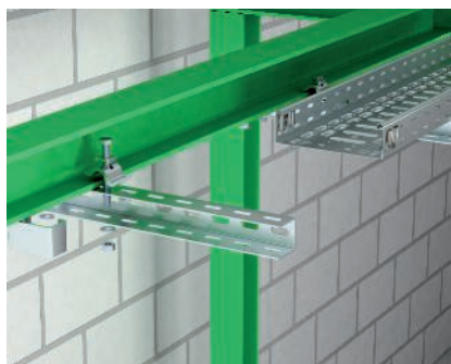
Krakovcový nosník na ocelové konstrukci Montáž profilu U jako krakovcového nosníku na ocelovém nosníku. Upevnění podle zatížení pomocí úhlových svorek nebo upínacích svorek. Upevnění rozpěrek typu DSK.
