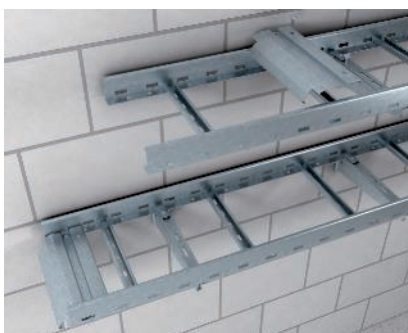
Kabelová odbočka svislá Při svislém odbočení kabelů nebo vedení se používá odbočný plech typu LAB pro zvětšení dosedací plochy kabelů a jejich ochranu.
