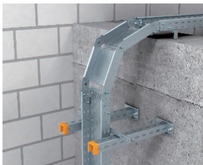
Montáž kloubového oblouku svislého, klesajícího Kloubový oblouk svislý klesající pro překlenutí výškových rozdílů. Kloubový oblouk se spojuje pomocí kloubových spojek s kabelovým žlabem.
